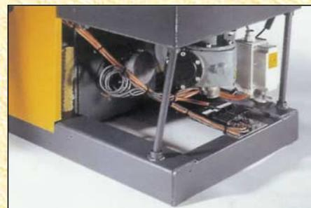
Vue du ventilateur à variation de vitesse, du moteur d'avancée et de recul du racleur d'amenée de combustibles ainsi que de la platine de fonctions.
